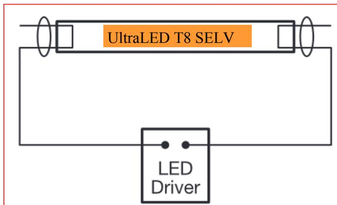
Simplex Schaltbild und einfache Installation. Keinerlei Zusatzaufwendungen, wie Drähte, Klemmen, ....
